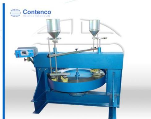
Abrasímetro Amsler, eletrônico, automático. Máquina para medir o desgaste por abrasão em materiais Cerâmicos, Rochas ou outros materiais inorgânicos. Podem ser ensaiados 2 Corpos de Prova simultaneamente.
