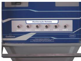
Entradas para lectura de LVDT´s
